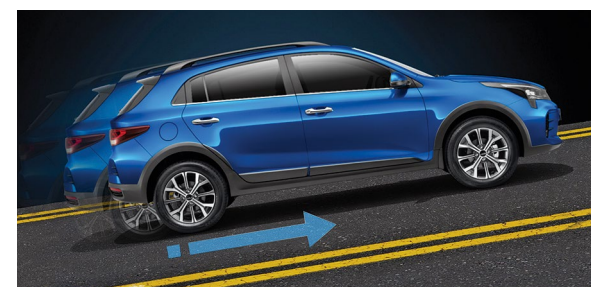
Система помощи при старте на подъеме (HAC) Когда вы трогаетесь с места на подъеме, система удержит тормоз в течение двух секунд, чтобы предотвратить откатывание назад.
